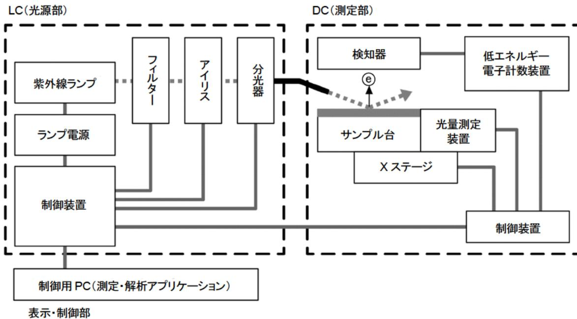
紫外線ランプから出た波長 200 - 300 nm の光を分光器で任意の波長に分光し、サンプル表面に照射します。
