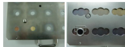
サンプルチェンジャー (左)板用チェンジャー、(右)粉用チェンジャー
