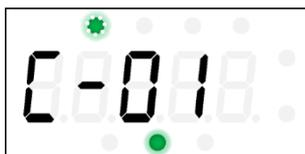
交換後のセンサが、交換前のセンサよりも製造年月日が同じ、または古い場合には、以下のように[C-01]と[USED]が交互に表示されます。
