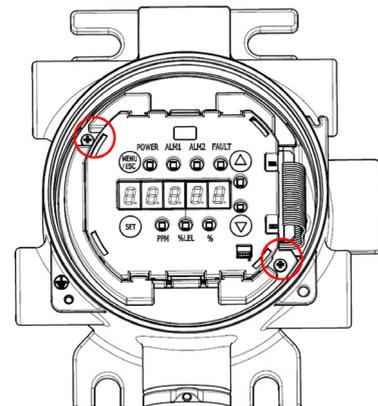
**11 蓋を時計回りに回して取り付け、六角穴付き止めねじ(M4)1本で固定する**
