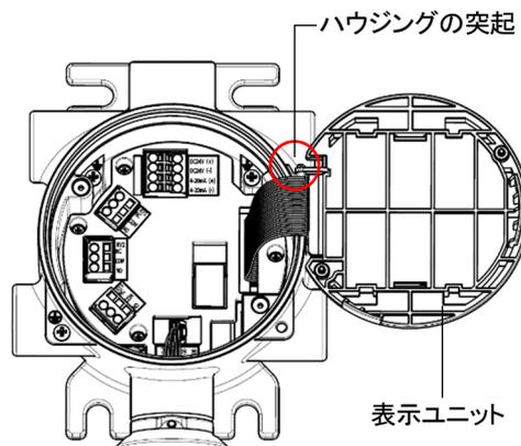
4 端子台基板にある端子台(TN2(Relay1:ALARM1)、TN3(Relay2:ALARM2)、TN4(Relay3:FAULT))を引き抜いて外す
