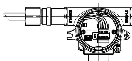
**8 蓋を時計回りに回して取り付け、六角穴付き止めねじ(M4)1本で固定する**
