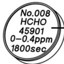
Messstreifen-Nr., Bezeichnung des Gases usw.
