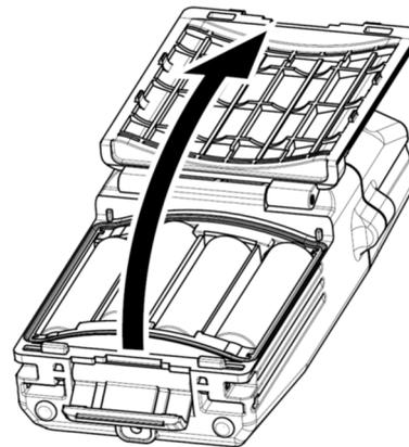
**4 Batteriefachabdeckung und Sicherungsplatte schließen.**
