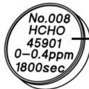
Messstreifen-Nr., Bezeichnung des Gases usw.
