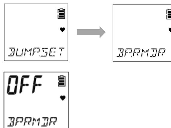
設定後顯示 [ END ]，返回通氣測試期限設定 (BUMP.SET) 的畫面。
