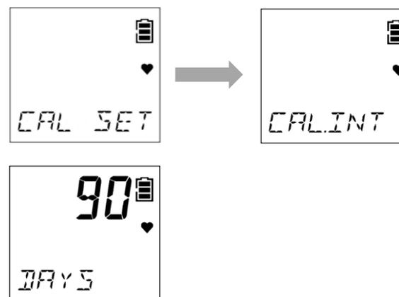
設定後顯示 [END]，返回校正期限設定 (CAL SET) 的畫面。
