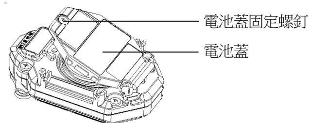
**3 拆下舊的電池，注意電池的極性，裝入新的電池**
