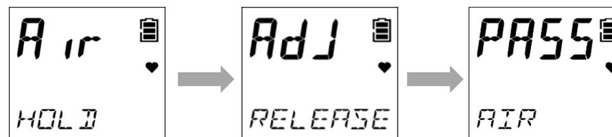
顯示空氣校正後的當前氣體濃度，返回氣體校正
