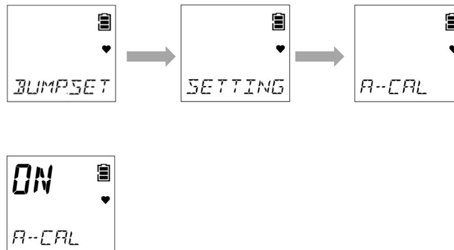
設定後顯示 [ END ]，返回通氣測試設定 (SETTING) 的畫面。
