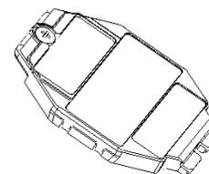
**4 關閉電池蓋，用十字螺絲起子旋緊電池蓋固定螺釘**
