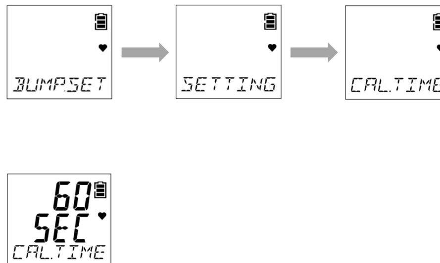
設定後顯示 [ END ]，返回通氣測試設定 (SETTING) 的畫面。
