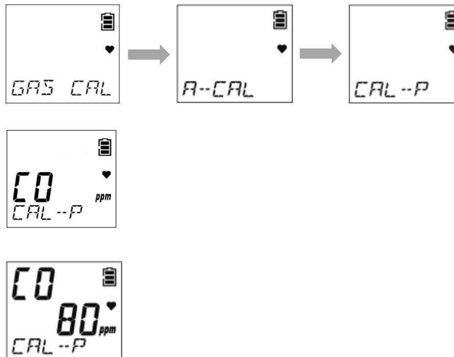
設定後顯示 [ END ]，返回 AUTO 校正 (A-CAL) 的畫面。
