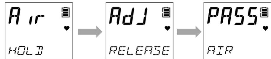
Após a calibração do ar, a concentração atual de gás é exibida e o visor retorna à tela de calibração (GAS CAL).
