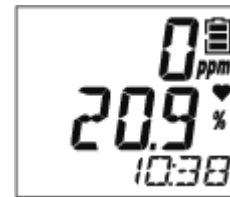
상단 행: CO (일산화탄소) 가스 농도 디스플레이 중간 행: O2 (산소) 가스 농도 디스플레이
