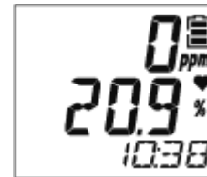
Obere Zeile: Anzeige der CO (Kohlenmonoxid)- Gaskonzentration Mittlere Zeile: Anzeige der O2 (Sauerstoff)- Gaskonzentration
