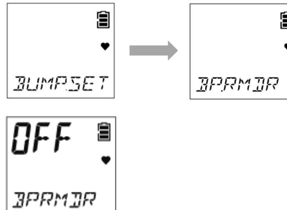
设定后显示 [END], 返回通气测试期限设定
