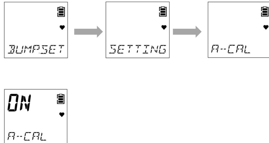
设定后显示 [END]，返回通气测试设定 (SETTING) 的画面。
