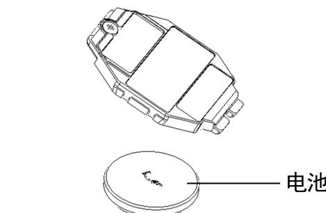
**4 关闭电池盖，用十字螺丝刀拧紧电池盖固定螺钉
