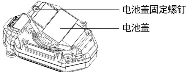
**3 拆下旧的电池，注意电池的极性，装入新的电池
