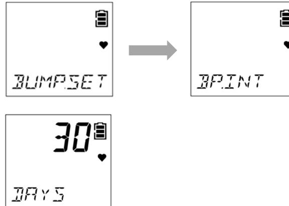
设定后显示 [END]，返回通气测试期限设定 (BUMP. SET) 的画面。
