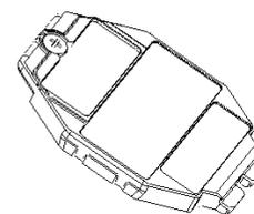
**4 关闭电池盖，用十字螺丝刀拧紧电池盖固定螺钉**
