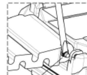
マイナスドライバー等でばね棒を引っ掛け穴に通す
