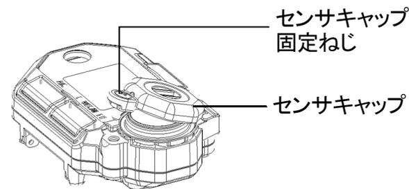
**3 センサキャップを取り外す****4 本器内部のダストフィルターと干渉ガス除去フィルター(CF-6280)を交換する****5 センサキャップを取り付け、センサキャップ固定ねじをプラスドライバーで締め付ける**
