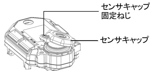
**3 センサキャップを取り外す****4 本器内部のダストフィルターと調湿フィルター(CF-A13i-1)を交換する****5 センサキャップを取り付け、センサキャップ固定ねじをプラスドライバーで締め付ける**
