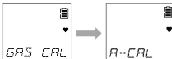
4 校正用ガスを導入し、60 秒後に POWER/MODE ボタンを押す
