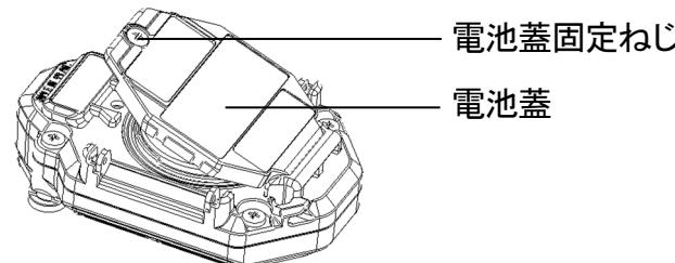
**3 古い電池を取り出し、電池の極性に注意して新しい電池を入れる**
