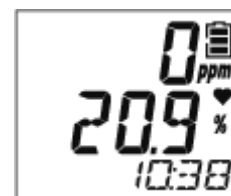
上段: CO(一酸化炭素)の ガス濃度表示
