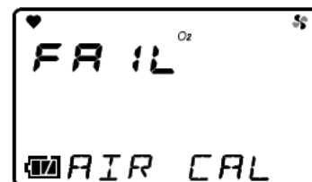
空氣校正不良 顯示例 氧氣(O 2 )感測器
