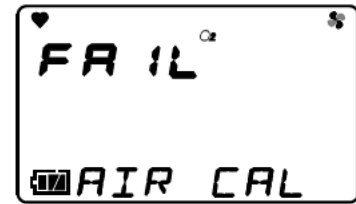
Beispiel für die Anzeige eines Luftkalibrierungsfehlers Sensor für Sauerstoff (O 2 )
