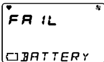
Anomalie der Batteriespannung
