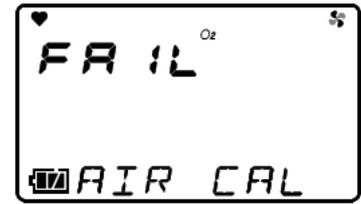
Exemplo de exibição de falha de calibração do ar
