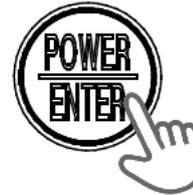
Mantenha pressionado o interruptor até que o visor LCD completo e a lâmpada do alarme se acenda e a buzina toque.
