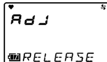
**3 Para o RX-8500, encaixe o filtro de remoção de CO<sub>2</sub> e pressione o interruptor ENTER.**
