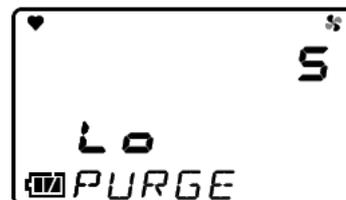
É efetuada uma operação de purga no modo medição [concentração alta] (HI) de H<sub>2</sub>S e, em seguida, o modo de medição [concentração baixa] (LO) de HC/O<sub>2</sub>/H<sub>2</sub>S.
