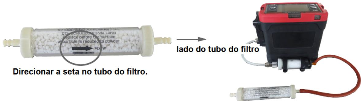
Coloque na vertical para remover o filtro CO<sub>2</sub> a usar. Com ele na horizontal, o CO<sub>2</sub> no ar pode não ser absorvido.
