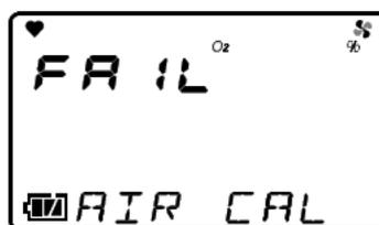
Falha de calibração
