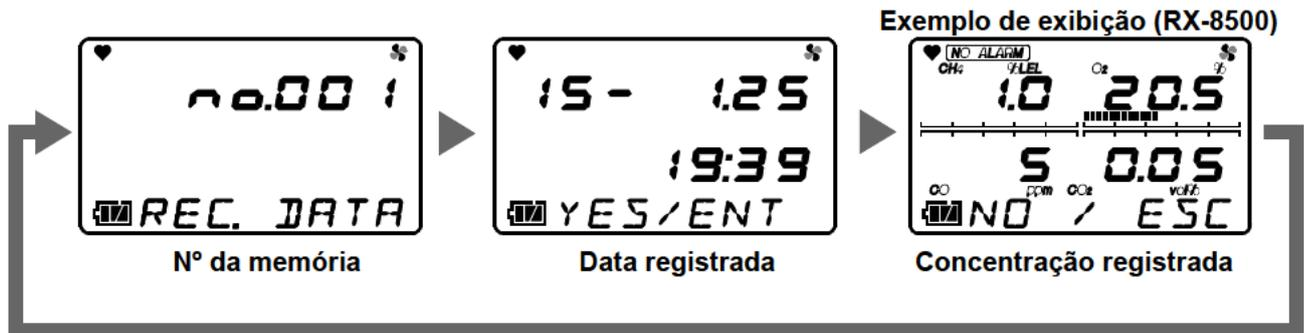
Pressione o interruptor ESC para avançar o registro dos conteúdos exibidos. A tela de medição volta a aparecer.
