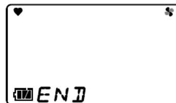
RX-8500 的显示例 (甲烷(CH4%LEL 校正时))
