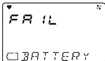
電池電圧異常
