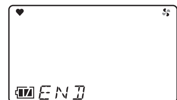
RX-8500 の表示例 (メタン(CH4%LEL 校正時))
