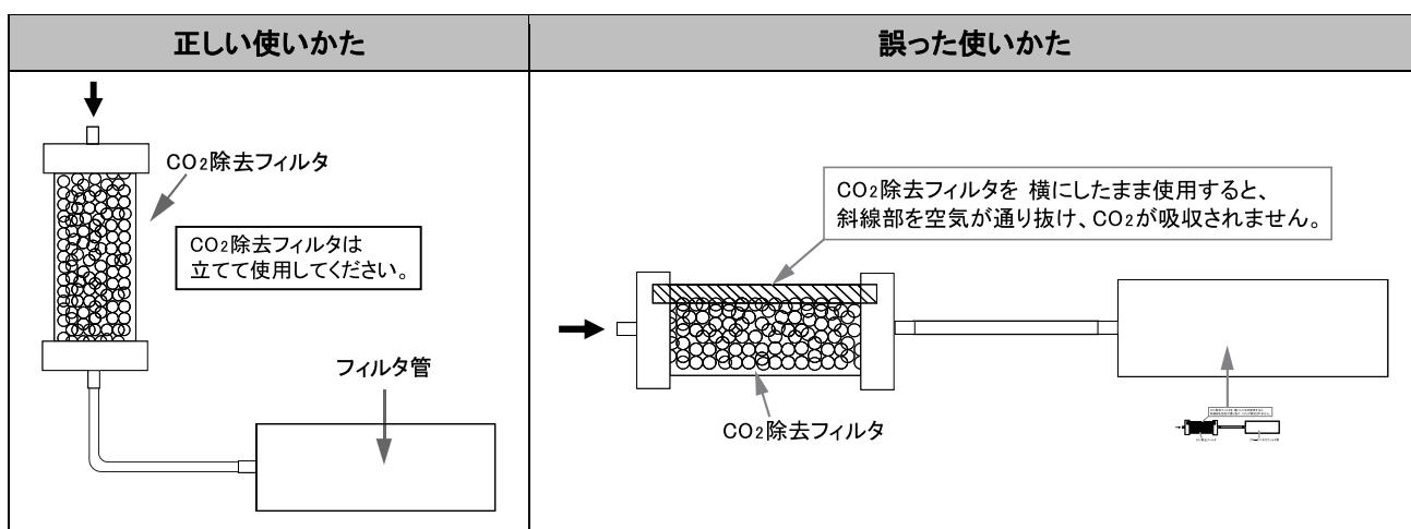
1本で使用可能な回数は、大気中の二酸化炭素濃度によって異なります。また、CO<sub>2</sub>除去フィルタの気密の度合い、保管温度、湿度によっても異なります。
