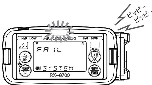
警報の種類は、流量低下異常、電池電圧異常、校正不良、センサ異常、システム異常、時計異常です。故障警報時の表示例を以下に示します。
