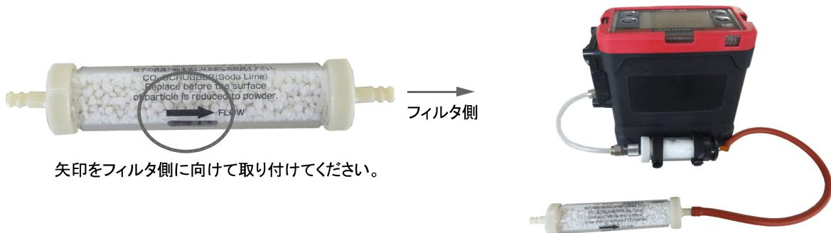
使用するときには、CO<sub>2</sub>除去フィルタを立ててください。横にしたまま吸引すると、空気中のCO<sub>2</sub>を吸収できない場合があります。
