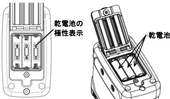
**3 電池カバーを閉じ、電池カバー固定ねじを締める**
