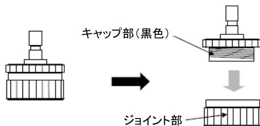
**2 右図のように、キャップ部(黒色)からダストフィルタを取り出し、新しいものに交換する**
