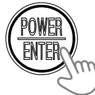
LCD が全点灯し、警報ランプが点灯してブザー音が“ピッ”と鳴るまで押してください。
