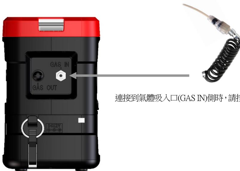
連接到氣體吸入口(GAS IN)側時，請按壓直到發出「咔嚓」聲牢固連接。
