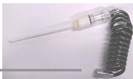
连接到气体吸入口(GAS IN)侧时，请按到一直到发出“咔嚓”声，牢固连接。
