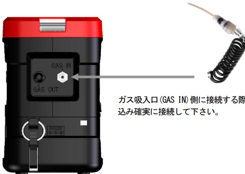
ガス吸入口(GAS IN)側に接続する際、「カチッ」と音がするまで押し込み確実に接続して下さい。
