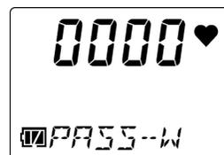
4 桁目を設定し、POWER/MODE ボタンを押すと、[END] と表示され、ユーザーモードメニューに戻ります。
