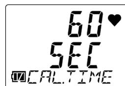
**<Ativar/Desativar calibração do teste de resposta (A-CAL)>**
