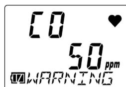
**4 Pressione o botão AIR várias vezes para definir o valor do ponto de ajuste do alarme e, em seguida, pressione o botão POWER/MODE.**
