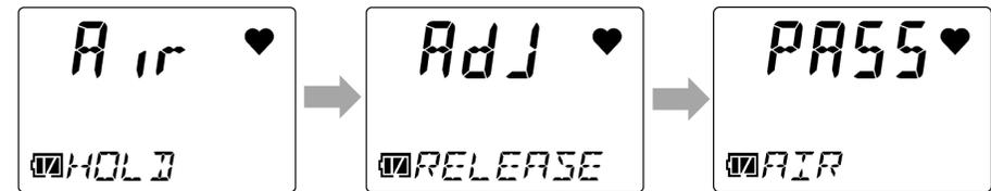
Após a calibração do ar, a concentração atual de gás é exibida e o visor retorna à tela [AIR].
