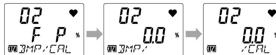
Após uma falha no teste de resposta, a calibração é realizada se especificado na configuração. Depois de concluída a calibração, o resultado da calibração é exibido na tela [BMP/CAL] (lado direito da linha do meio) e, cada vez que o botão AIR é pressionado, o visor mostra a leitura no momento do teste de resposta e da leitura da calibração.
