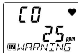
Defina cada ponto de ajuste de alarme dentro do intervalo válido de pontos de ajuste.
