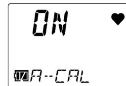
Nach Abschluss der Einstellungen wird [END] angezeigt. Die Anzeige kehrt zum Bildschirm [A-CAL] zurück.
