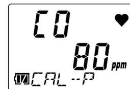
Nach Abschluss der Einstellungen wird [END] angezeigt. Die Anzeige kehrt zum Bildschirm [CAL-P] (Zielgasauswahl) zurück.
