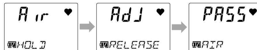
顯示空氣校正後當前的氣體濃度，並返回 [ AIR ] 的畫面。
