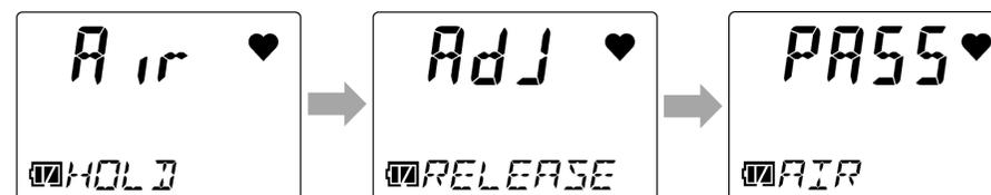
エア校正後の現在のガス濃度が表示され、[AIR]の画面に戻ります。
