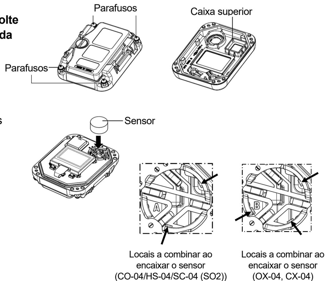
**6 Retorne a caixa superior para sua posição original. Aperte os quatro parafusos com a chave de fenda Phillips.**
