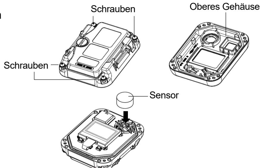
**6 Oberes Gehäuse wieder in seine ursprüngliche Position bringen. Die vier Schrauben mit dem Kreuzschlitz-Schraubendreher festziehen.**
