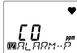
**3 Zum Auswählen des Alarmtyps POWER/MODE-Taste mehrmals drücken.**
