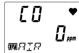
**4 AIR-Taste loslassen, sobald die LCD-Anzeige von [Air HOLD] zu [AdJ RELEASE] wechselt.**
