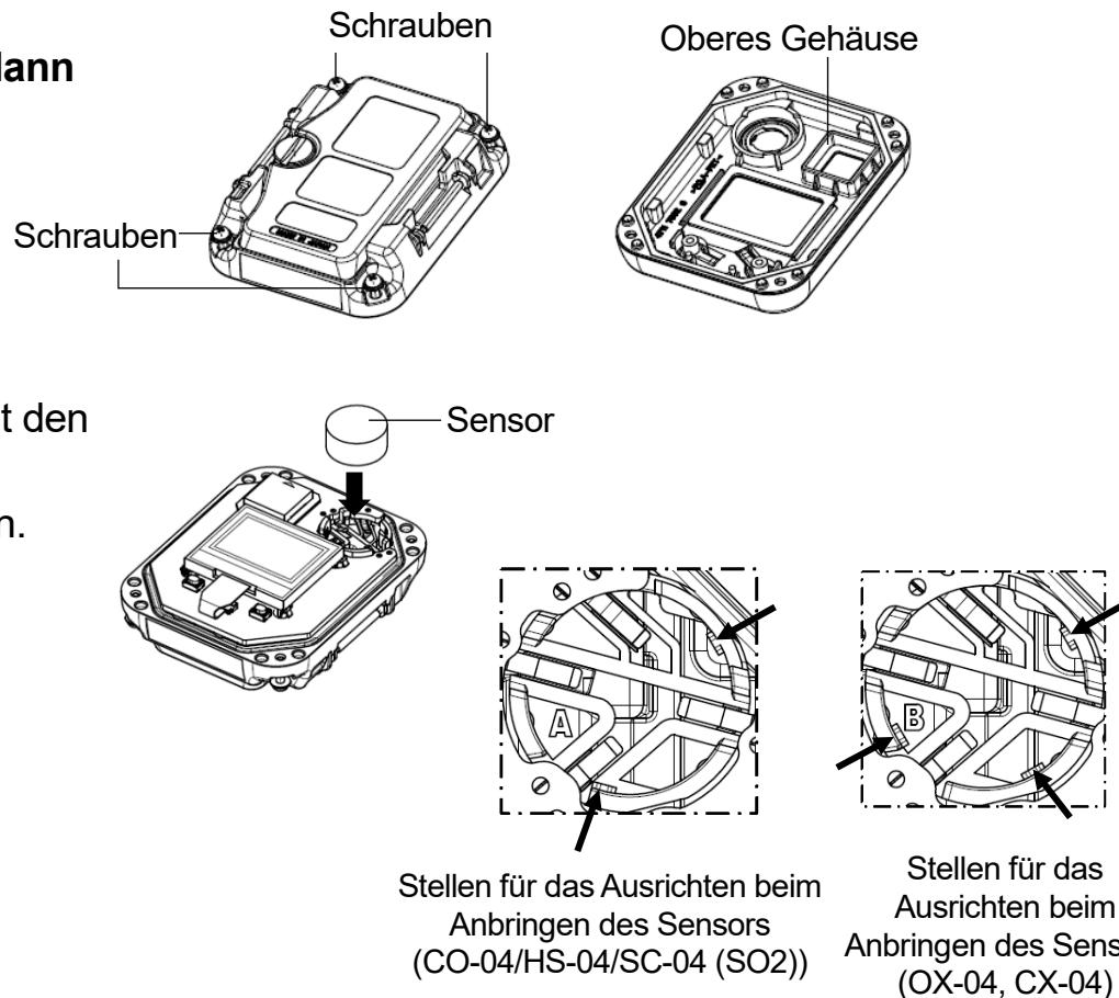
**6 Oberes Gehäuse wieder in seine ursprüngliche Position bringen. Die vier Schrauben mit dem Kreuzschlitz-Schraubendreher festziehen.**
