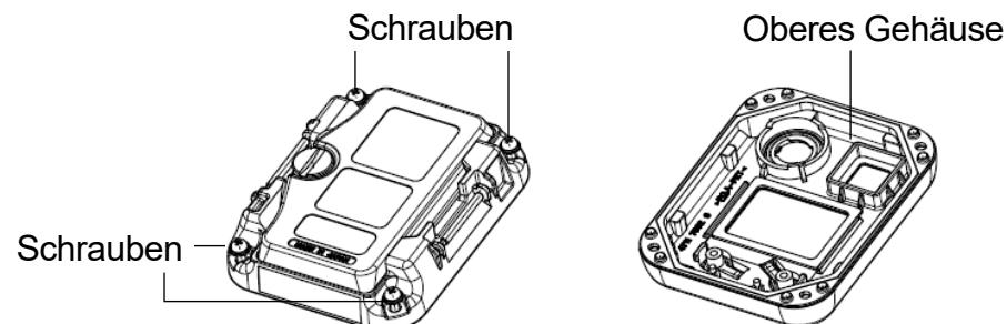
**5 Filter, Gummidichtung und Staubfilter vom oberen Gehäuse entfernen.****6 Staubfilter austauschen.****7 Gummidichtung anbringen.**
