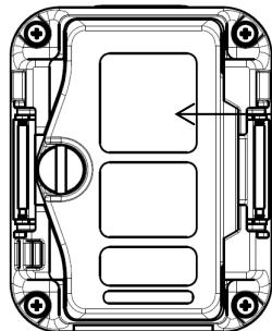
Übliches Typenschild für Modelle mit Konformitätsbescheinigung für Elektrogeräte, die in explosionsgefährdeten Bereichen verwendet werden (japanische Explosionsschutz-Norm)
