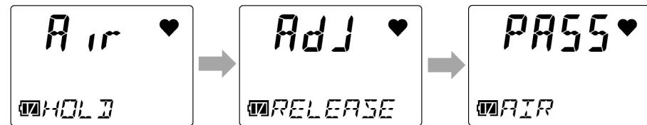
Nach der Luftkalibrierung wird die aktuelle Gaskonzentration angezeigt und die Anzeige kehrt zum Bildschirm [AIR] zurück.
