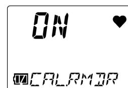
Nach Abschluss der Einstellungen wird [END] angezeigt. Die Anzeige kehrt zum Bildschirm [CAL.RMDR] zurück.
