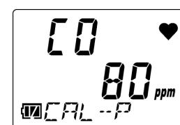
Nach Abschluss der Einstellungen wird [END] angezeigt. Die Anzeige kehrt zum Bildschirm [CAL-P] (Zielgasbestätigung) zurück.
