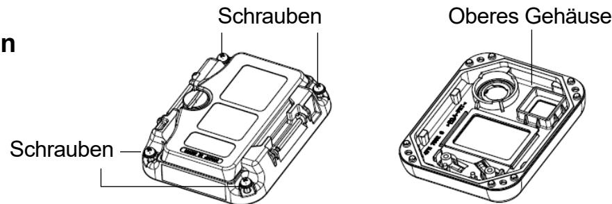
**5 Gummidichtung und Staubfilter vom oberen Gehäuse entfernen.**
