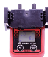
Exemple montrant l'adaptateur d'étalonnage fixé
