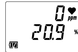
상단: [CO](일산화탄소) 가스농도표시 중단: [O2](산소) 가스농도표시
