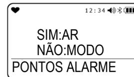
Pressionar o botão **AIR** faz o visor percorrer em ciclo “ESCALA MÁXIMA” → “WARNING” → “ALARM” → “ALARM H” → “STEL” → “TWA” → “ESCALA MÁXIMA” → ...
