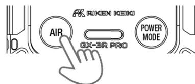
Aparece a tela de calibração do ar. Mantenha o botão AIR pressionado enquanto for exibida a tela mostrada à direita. A calibração do ar não será executada se soltar o botão antes que a tela seja exibida ou enquanto é exibida.
