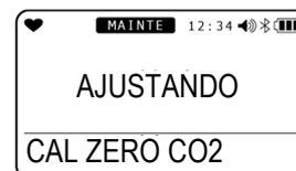
A concentração atual após a calibração zero de CO<sub>2</sub> é exibida. O visor retorna à tela do menu de calibração. “FALHA” é exibido se a calibração não foi bem sucedida. Aparece “FIM” e o visor retorna à tela do menu de calibração.
