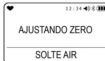
Se a calibração do ar tiver sido completada com sucesso, o visor retorna automaticamente à tela do modo de medição.
