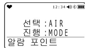
AIR 버튼을 누르면 “풀 스케일” → “WARNING” → “ALARM” → “ALARM H” → “STEL” → “TWA” → “풀 스케일” → ... 순서대로 표시가 순환합니다.
