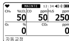
일본 Ex 사양 한정으로 자동 보정이 성공적으로 수행된 후 자동 보정 후의 농도 및 센서 예비 값이 표시됩니다.
