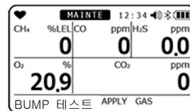
보정이 범프 테스트 실패 후에 수행하도록 명시가 되어있는 경우에는 범프 테스트가 실패하면 보정을 자동으로 수행합니다.
