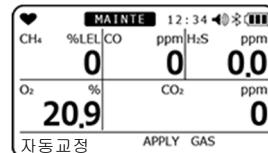
범프 테스트와 보정이 완료되면 범프 테스트 결과(좌측), 보정 결과(우측)가 범프 테스트 시 및 보정 후의 판독값과 함께 표시됩니다.
