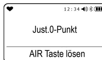
Wenn die Luftkalibrierung erfolgreich abgeschlossen ist, kehrt die Anzeige automatisch zum Messmodus-Bildschirm zurück.
