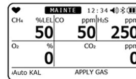
Die autom. Kalibrierung wird durchgeführt.
