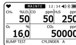
Zylinder A bis E werden nacheinander angezeigt. Durch erneutes Drücken der **AIR**-Taste wird „Zurück“ angezeigt und die Anzeige kehrt zum Bildschirm in Schritt 1 zurück.
