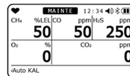
Nur bei Japan Ex-Spezifikation werden die Konzentration und der Sensorreservewert nach der autom. Kalibrierung angezeigt, nachdem die autom. Kalibrierung erfolgreich durchgeführt wurde.
