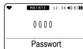
Das Benutzermodus-Menü wird angezeigt, sobald das Passwort korrekt eingegeben wurde. Wenn das eingegebene Passwort falsch ist, wird ein Fehler angezeigt. Die Anzeige wechselt zu „Bildschirmübergang vom Einschalten zur Anzeige des Messbildschirms“ in „5-3. Inbetriebnahme“.
