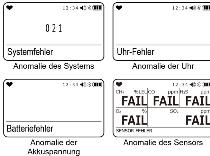
Ermitteln Sie bei Auftreten eines Fehleralarms die Ursache und ergreifen Sie geeignete Maßnahmen.
