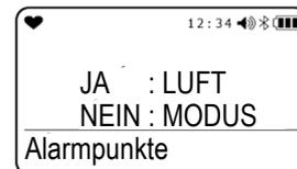
Durch Drücken der AIR-Taste wird nacheinander „VOLLSKALA“ → „WARNING“ → „ALARM“ → „ALARM H“ → „STEL“ → „TWA“ → „VOLLSKALA“ → ... angezeigt.
