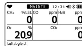
Die Luftkalibrierung wird durchgeführt.
