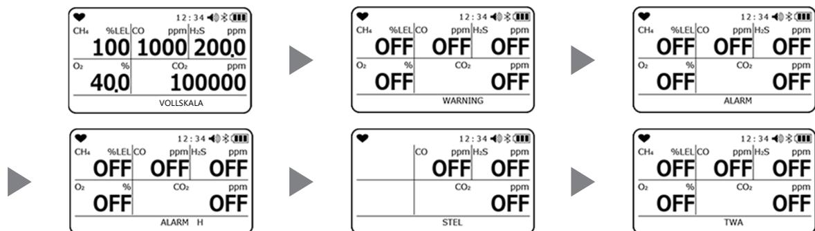
Der entsprechende Alarm kann durch gleichzeitiges Drücken der AIR-Taste und der MODE-Taste getestet werden. Beliebige Taste drücken, um den Alarm zurückzusetzen.
