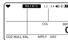
CO<sub>2</sub>-Nullkalibrierung wird durchgeführt.
