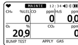
Gas für den Bump-Test zuführen. Der Bump-Test wird durchgeführt.
