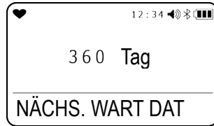
Anzeige des Kalibrierungsablaufdatums * Nur bei ATEX/IECEX-Spezifikationen angezeigt
