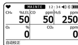
仅 Japan Ex 规格，自动校正成功后显示自动校正后的浓度和传感器余力值。
