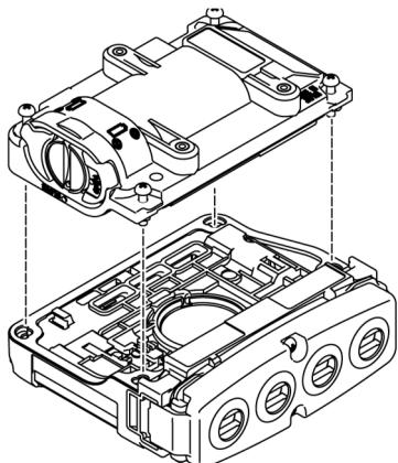
**3 安装电池单元时，用 4 根螺丝固定**
