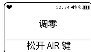
正常进行 AIR 校正后, 自动返回测量模式画面。
