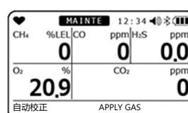
BUMP 测试及气体校正结束后，显示 BUMP 测试结果
