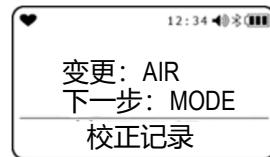
每次按下 AIR 按钮，按 “CH<sub>4</sub>” → “O<sub>2</sub>” → “H<sub>2</sub>S” → “CO” → “CO<sub>2</sub>” → · · · 的顺序显示。
