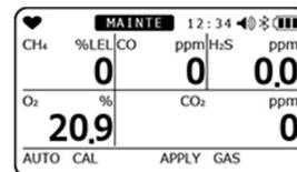
バンプテスト、およびガス校正終了後、バンプテスト結果(左)、およびガス校正結果(右)、バンプテスト時の指示値、ガス校正後の指示値が表示されます。
