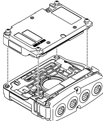
**3 リチウムイオン電池ユニットを取り付ける場合は、4 本のネジで固定する**
