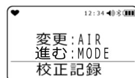
**AIR** ボタンを押すたびに、「CH<sub>4</sub>」→「O<sub>2</sub>」→「H<sub>2</sub>S」→「CO」→「CO<sub>2</sub>」→……の順に表示されます。
