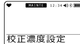
**4 AIR** ボタンを押して、校正ガスの種類を選択する
