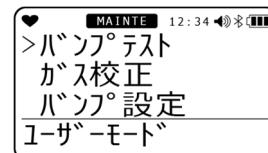
**2 AIR** ボタンを押して、バンプテストを行うシリンドラーを選択する
