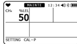
**6 AIR** ボタンを押して、校正濃度を選択し、**MODE** ボタンを押す
