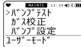
**2 AIR** ボタンを押して、バンプテストを行うシリンドーを選択する
