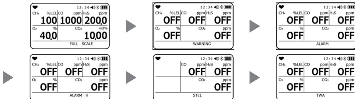
**AIR** ボタンと **MODE** ボタンを同時に押すと、当該警報の作動テストができます。警報を解除するには、いずれかのボタンを押します。
