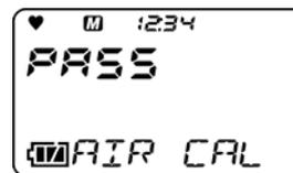
顯示空氣校正後當前的濃度，並返回氣體校正的選項畫面。
