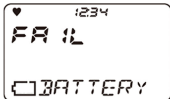
Anomalia de tensão da bateria
