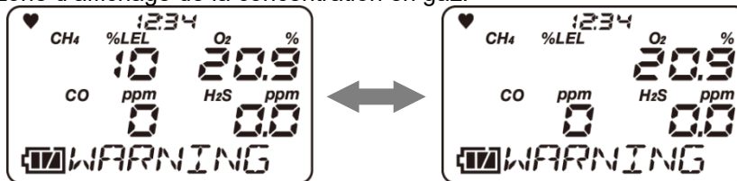
Exemple d'affichage Concentration en méthane (CH 4 ) : [10 %LEL] Première alarme déclenchée
