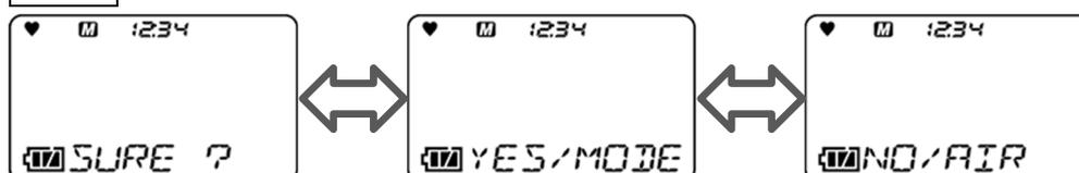
Der Bildschirm zur Bestätigung des Zurücksetzens der Alarmsollwerte wird angezeigt.
