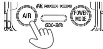
Der Bildschirm für die Luftkalibrierung wird angezeigt.
