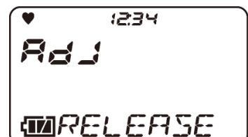
正常进行 AIR 校正后，自动返回测量模式画面。
