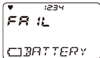
電池電圧異常
