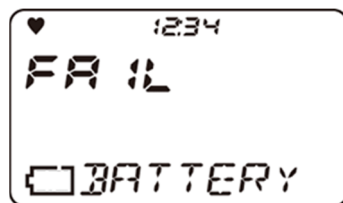
電池電圧異常
